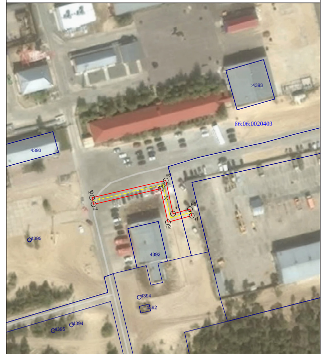
Используемые условные знаки и обозначения: Масштаб 1:1000 - Граница, устанавливаемой зоны публичного сервитута н1 - Характерная точка границы устанавливаемой зоны публичного сервитута - ось газопровода 86-05-0401001 - Номер кадастрового квартала
